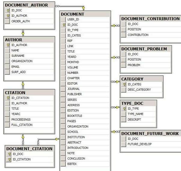
**Figure 2.** Database schema
